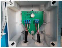
Проверка электродов датчика проста: замыкания между контактами 1 и 3, а также между контактами 2 и 3 не должно быть.
